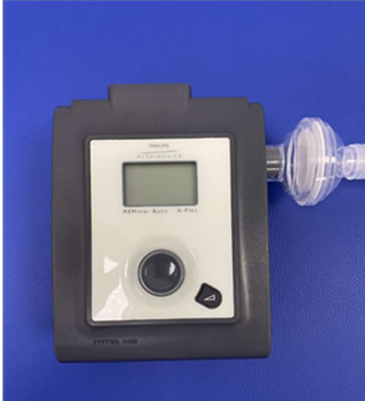
Figura 3.- Colocación del filtro antivirico previo al equipo
