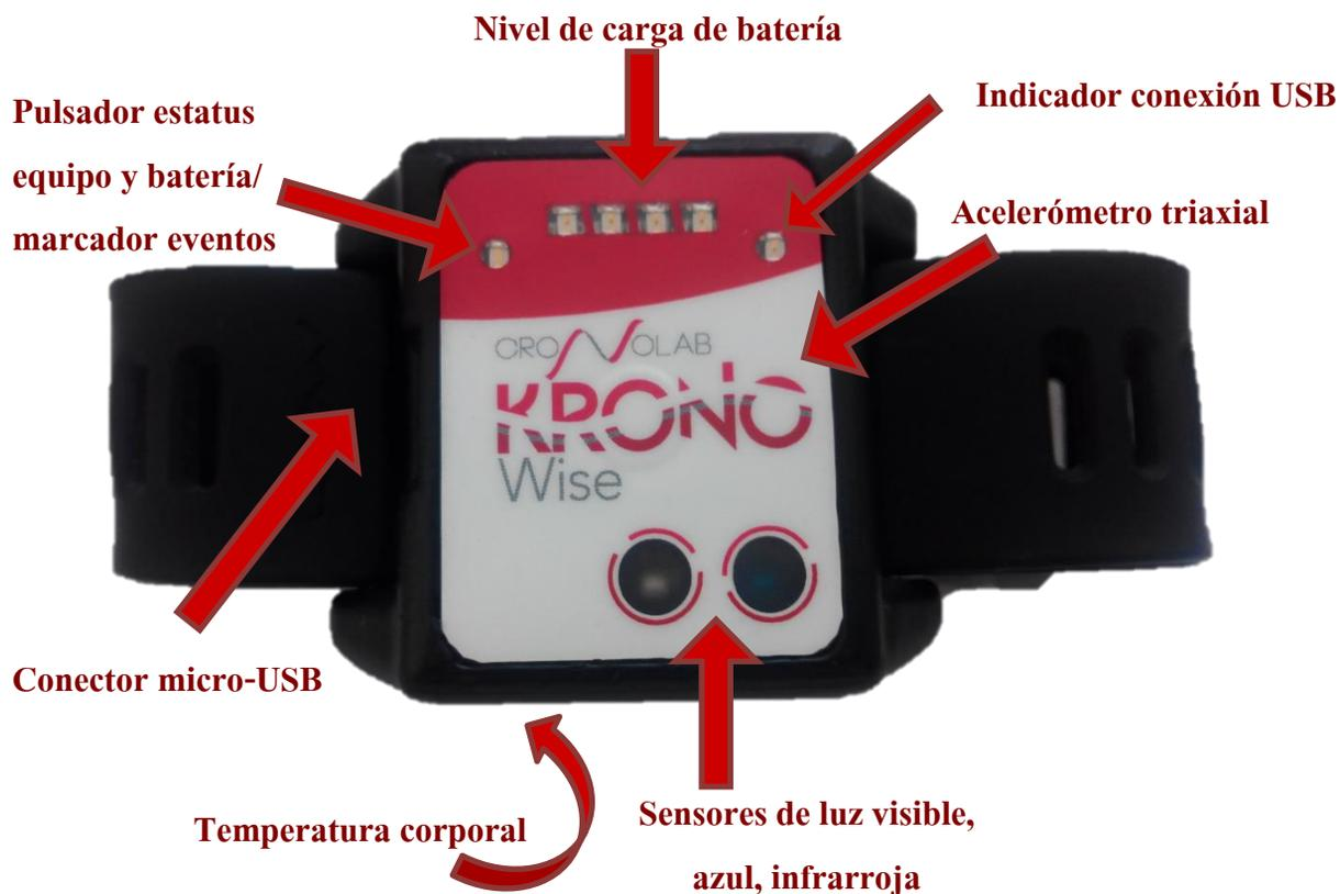
Mientras el registro de datos se encuentra activo, los datos se van almacenando en una memoria interna y pueden ser descargados en cualquier momento conectando la unidad mediante un cable tipo micro-USB a un ordenador en el que se haya instalado el software suministrado. La unidad se alimenta de una batería interna de litio que se recarga a través del citado cable cuando sea conectado a un puerto USB del ordenador, o bien a un cargador USB standard de 5 V (con un amperaje mínimo de 500 mA).
